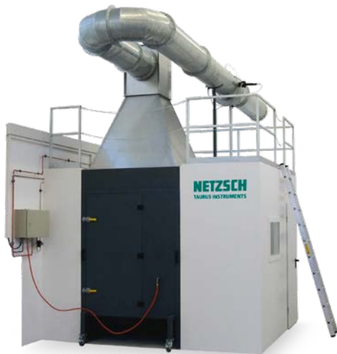
SBI 915 – Brandprüfeinrichtung für Bauprodukte
