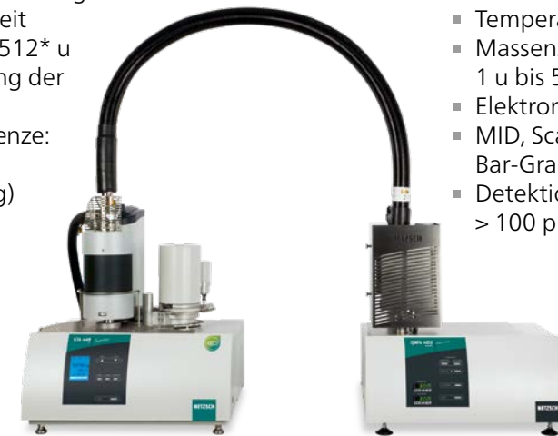
STA 449 F1 Jupiter® gekoppelt mit einem QMS 403 Aeolos® Quadro
