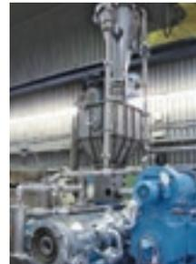
Trocknung und Extrusion in einem Schritt. Das Verfahren basiert auf dem Prinzip der Rückwärtsentgasung
