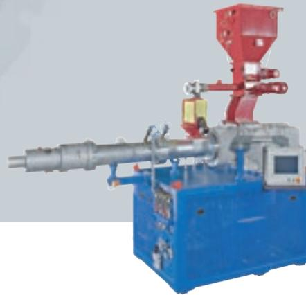
TP-WE 180 M1 mit Mittenzentrierung für die Verarbeitung von Gummi, mit einer Ausstoßleistung von 1.200 kg/h und einer Antriebsleistung von 250 kW
