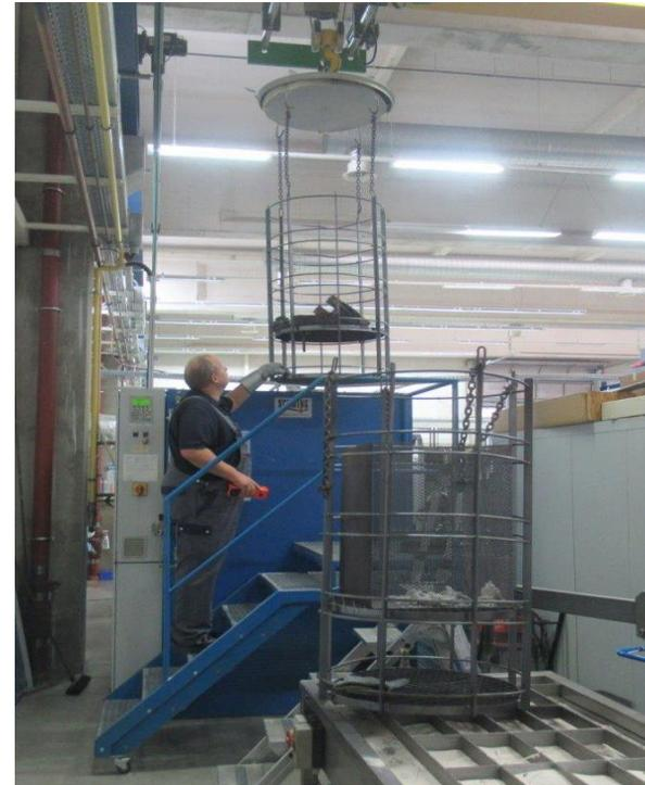
Bestücken des Wirbelbett-Ofens mit Heißkanal-Verteilern zur Reinigung.
