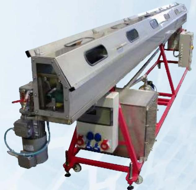
Sprühkühlbad mit integriertem Transportband
