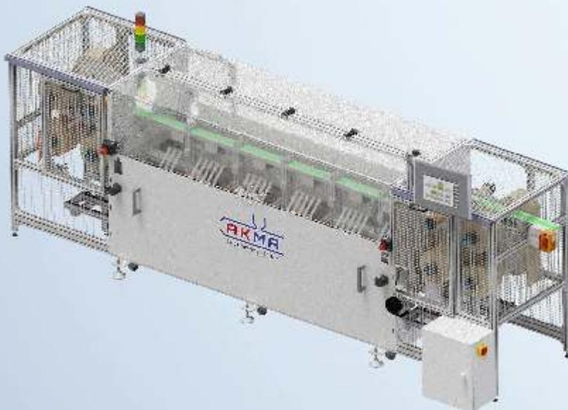
3D CAD unterstützte Entwicklung einer automatisierten Abstapel-, und Verpackungsanlage für geschnittene PVC Schläuche.
