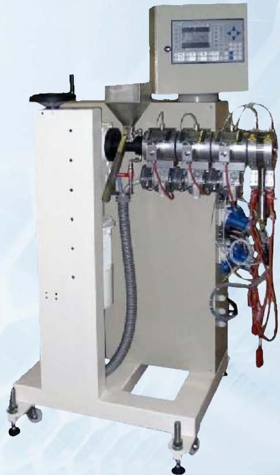
Co-Extruder, verfahrbar, drehbar, mit Einzelreglern
