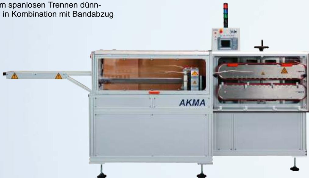
Trennanlage zum spanlosen Trennen dünnwandiger Rohre
