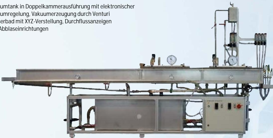
Wasserbad mit XYZ-Verstellung, Durchflussanzeigen und Abblaseinrichtungen
