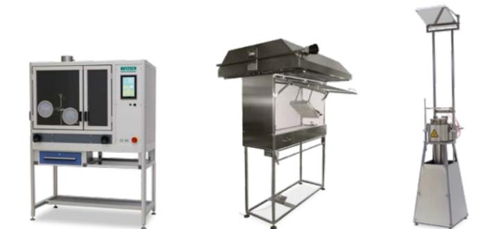
UL 94 – Brandprüfeinrichtung für elektro-technische Produkte
